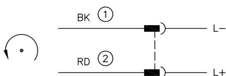
电机轴的旋转方向：逆时针方向（从轴端部看）
