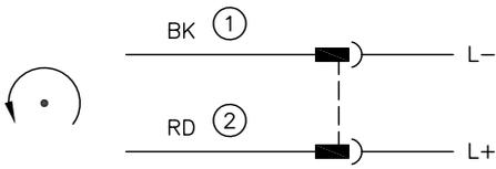
电机轴的旋转方向：逆时针方向（从轴端部看）
